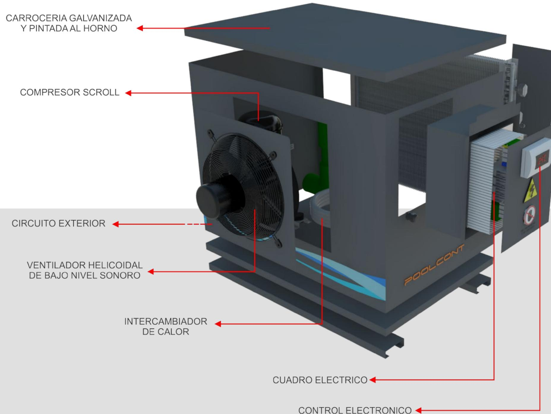
**Circuito Frigorífico:** - Compresor scroll, montado sobre tacos antivibratorios - Válvula de expansión termo-mecánica (según modelo) - Filtro deshidratador antiácido - Válvula de 4 vías para inversión de ciclo - Refrigerante R407C - Insonorización acústica tanto en compresor como en bastidor (opcional).
